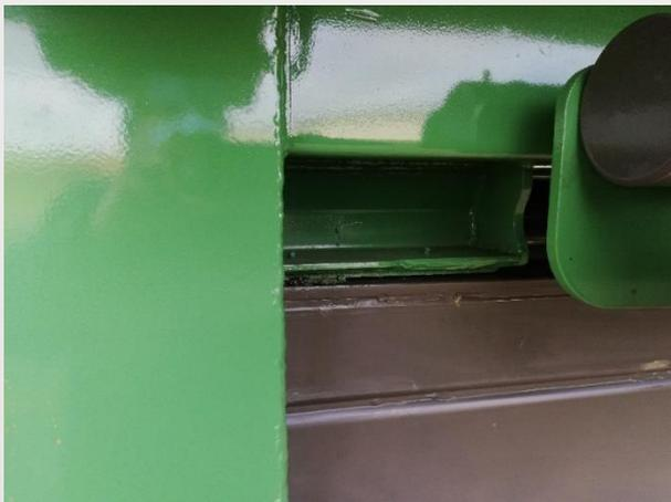
Les caissons et le poussoir reposent sur des patins fabriqués dans un polymère anti abrasif et autolubrifiant
